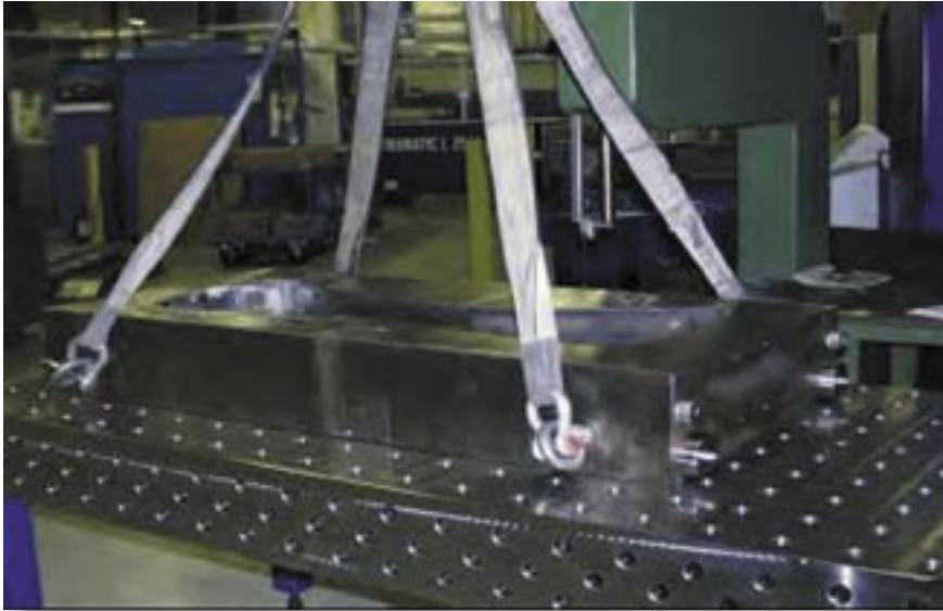
Bild 5: 99,7 % Metallfüllgrad des WZ - voll bearbeitbar
